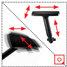
P 52 B: regulowane podłokietniki góra - dół (zakres 80 mm). Miękka nakładka wykonana z PU. Mechanizm przesuwu nakładki przód - tył (zakres 50 mm) i na szerokość (zakres 30 mm). Konstrukcja nylon czarny.
