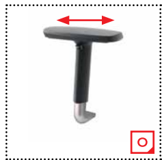
P 49 C: regulowane podłokietniki góra-dół (zakres 80 mm). Miękka nakładka wykonana z PU, z mechanizmem przesuwu przód-tył (zakres 60 mm). Konstrukcja aluminium polerowane.
